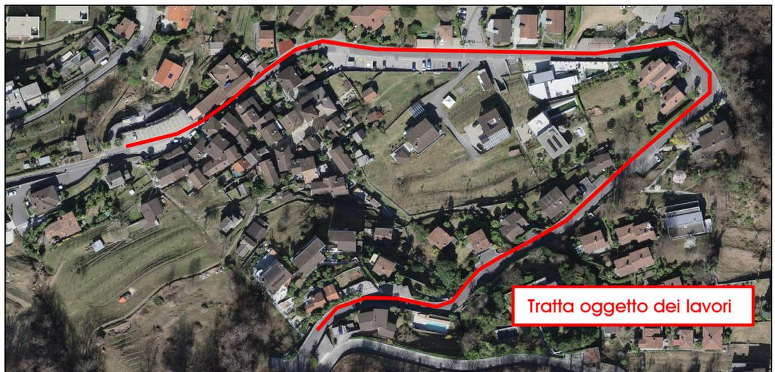
Le infrastrutture elettriche presenti nella zona sono ancora aeree, pertanto la Società Elettrica Sopracenerina procede con la posa delle nuove sottostrutture lungo il tratto di strada in oggetto per poi procedere all'eliminazione delle linee aeree e relativi pali in legno di sostegno.
