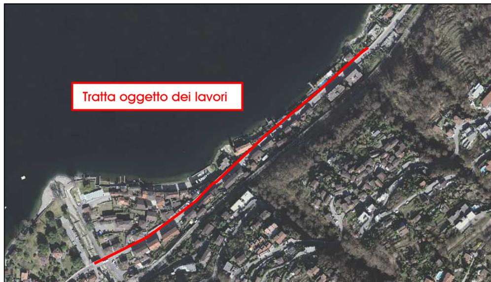
La Società Elettrica Sopracenerina procede con il potenziamento delle proprie infrastrutture elettriche lungo tutta la tratta così da eliminare le linee aeree ancora presenti e garantire le future necessarie condotte interrato per l'ammodernamento della linea a media tensione (16kV), necessaria per l'approvvigionamento elettrico delle frazioni di Gerra, Sant'Abbondio e Caviano.
