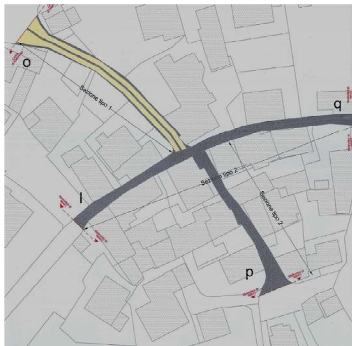
Nella zona interessata dai lavori di pavimentazione sono presenti le condotte dell'acqua potabile e le canalizzazioni comunali. Entrambe sono assai datate e presentano difetti strutturali che rendono necessaria la loro sostituzione.
