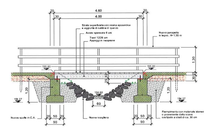
Figura 6: Nuovo ponticello - Sezione longitudinale
