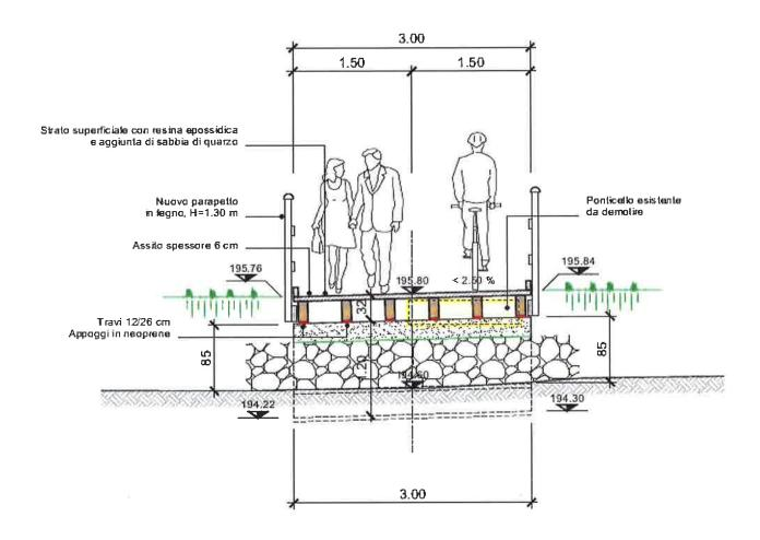
Figura 7: Nuovo ponticello - Sezione trasversale
