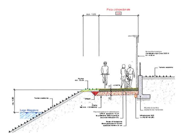
Figura 5: Sezione tipo muro privato
